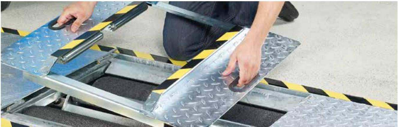
Der Pkw-Bremsenprüfstand BD Serie 4 kann zur Prüfung von Motorradbremsen mit Hilfe eines Abdeckblechs umgerüstet werden. Prüfung mit Screen Lane Software. (Abdeckblech 1 691 601 208, USB-Konverter 935 601 103, Screen Lane Software 935 701 033)
