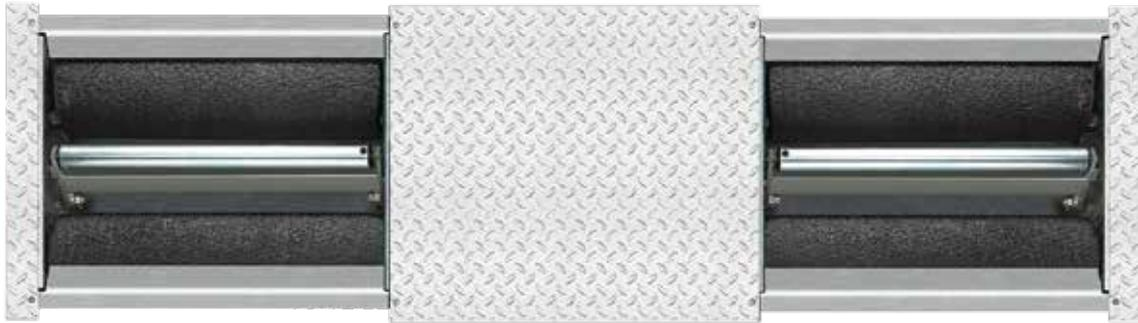
**700 mm Rollenlänge:** 2,5 t Achslast, max. 4 t Überfahrlast; Prüfbreite min. 800 mm, max. 2 200 mm
